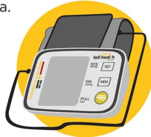
Conecte el tubo del brazalete al lado izquierdo del dispositivo.
